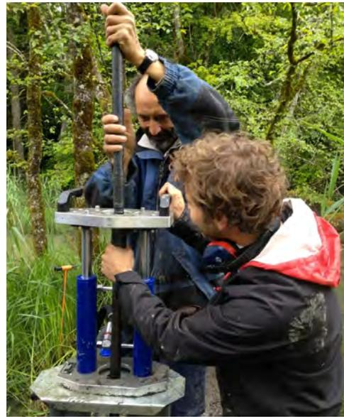
Carottage dans le bras-mort du Rhône d'Eau Morte (Basses Terres dauphinoises, 2016) : 6,10m sur les graviers, soit 1,70m de plus que les carottages antérieurs (n<sup>elles</sup> analyses)
