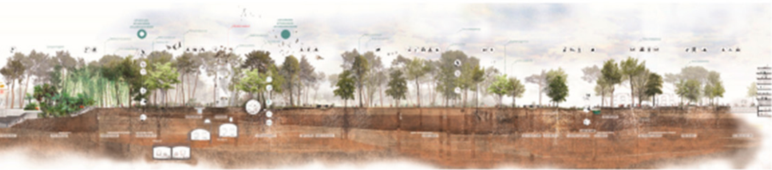
Retrouver des sols profonds – Vue en coupe du principe de reconquête des sols – Place des Gloires Catalanes et ramblas – Barcelone
